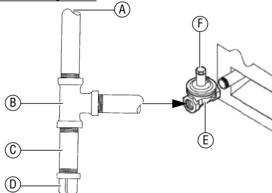
A Al suministro de gas con la instalación de B, C y D en una orientación vertical como se muestra para la captación de desechos.
