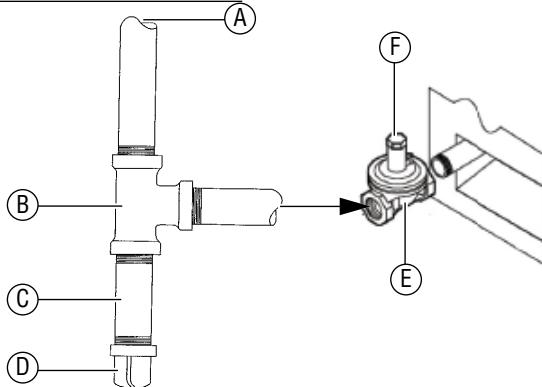
À l'arrivée de gaz avec l'installation de B, C et D dans une orientation verticale, comme illustré pour permettre la capture des débris.
