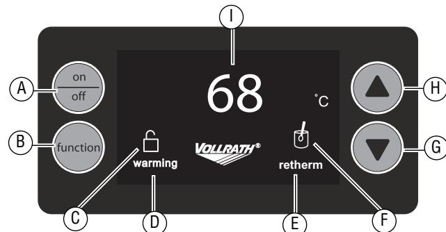
**A** **Botón de encendido/apagado (ON/OFF).** Púlselo para encender el equipo.
