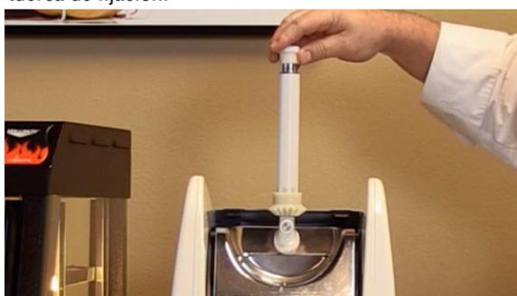
**4** Empuje el engranaje en la parte posterior del tornillo sin fin horizontal. Lubrique los dientes del engranaje con lubricante apto para alimentos.
