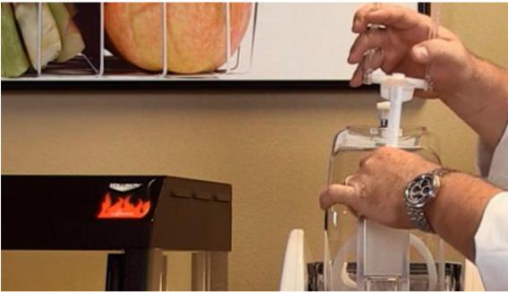
**4** Saque las perillas de fijación del tanque.
