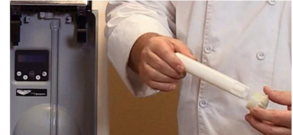
**13** Con la herramienta que viene con la máquina, levante suavemente las juntas tóricas.
