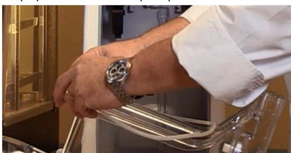
**8** Instale el tanque. Afícelo con abrazaderas. Atornille las perillas de fijación en las abrazaderas.
