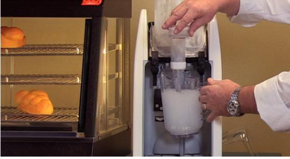
**3** Llene el tanque con 1 galón (3,8 litros) de agua potable.
