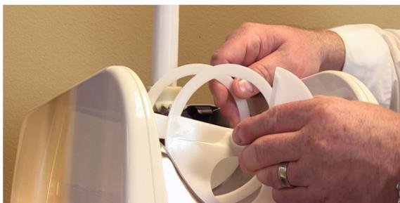
**6** Lubrique la parte delantera del tornillo sin fin con lubricante apto para alimentos.
