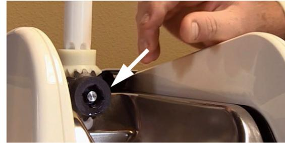
**10** Destornille la tuerca en la parte superior del eje motriz.
