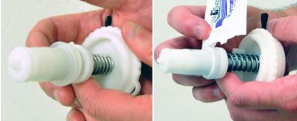
**13** Installez le robinet. Tournez le joint torique dans le sens des aiguilles d'une montre jusqu'au déclic confirmant son blocage en position.
