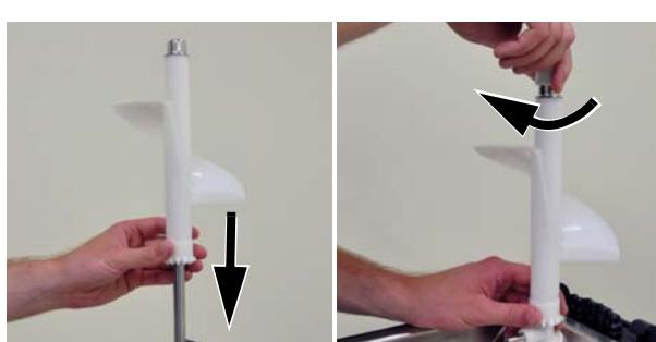
**4** Vérifiez que la douille est en place. Pressez l'engrenage sur l'arrière de la tarière horizontale.
