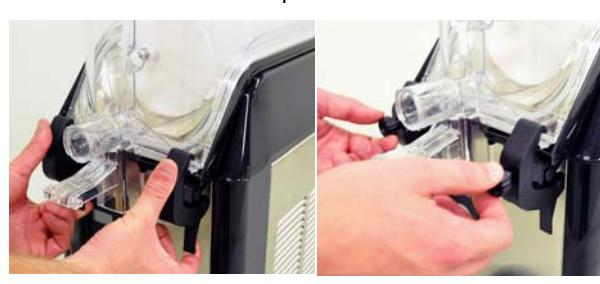
**10** Installez les joints toriques sur le bouton de maintien de la tarière horizontale. Appliquez une fine couche de lubrifiant sans danger pour les aliments.
