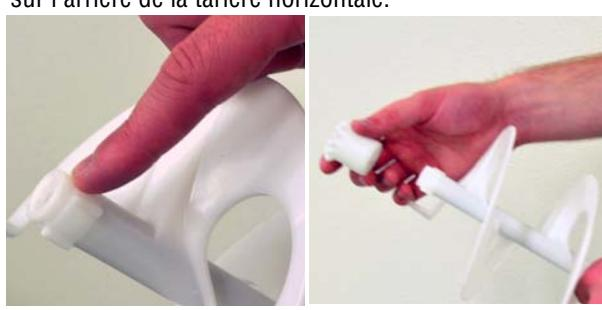
**5** Lubrifiez la denture et l'extrémité métallique de la tarière avec un lubrifiant sans danger pour les aliments.
