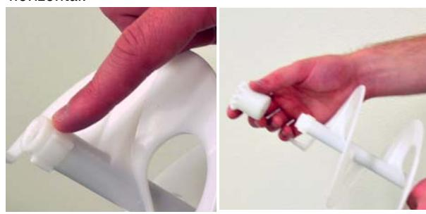
**5** Lubrique los dientes del engranaje y la punta metálica del tornillo sinfín con lubricante apto para alimentos.
