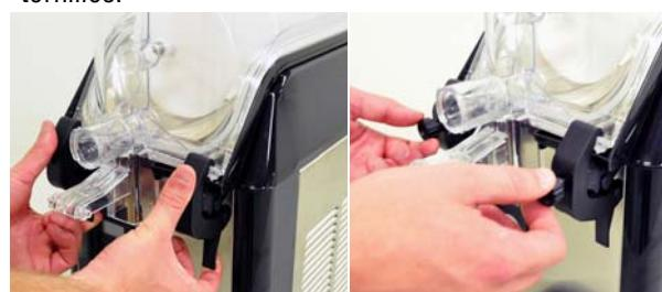
**10** Instale las juntas tóricas en la perilla de apoyo del tornillo sinfín horizontal. Aplique una capa delgada de lubricante apto para alimentos.
