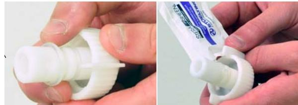
**11** Inserte la perilla de apoyo del tornillo sinfín horizontal. Presione firmemente perilla y gírela en sentido horario.
