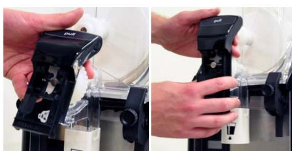
**15** Instale la o las bandejas de goteo.
