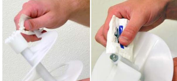
**6** Instale el tornillo sinfín horizontal en la máquina.
